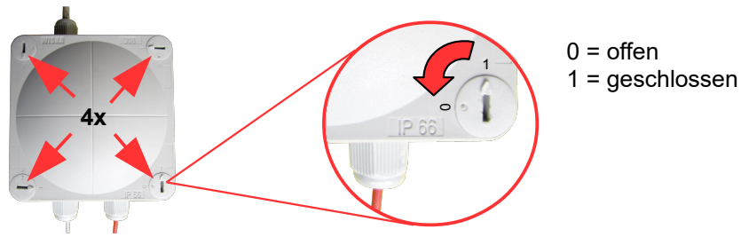
Abbildung 4: Deckel vom Messwertaufnehmer abnehmen
