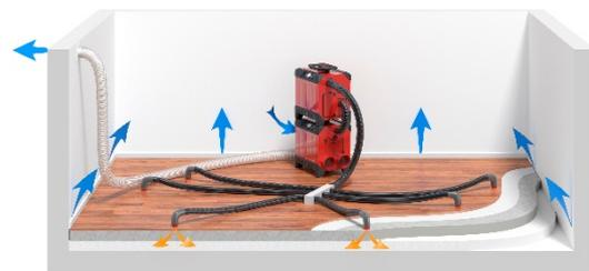
Assèchement par insufflation. La turbine est alimentée en air sec provenant du déshydrateur et le refoule dans la structure multicouches.
