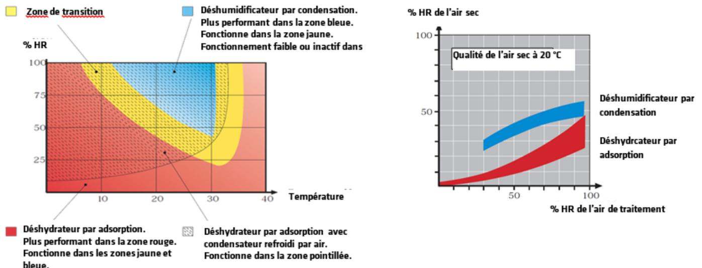
Le déshumidificateur par condensation est utilisé, comme le montre le graphique ci-dessus, de préférence dans des espaces chauds et humides, à la condition que l'objectif premier soit l'assèchement de la pièce.
