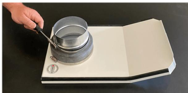
4. Die 140 mm Schlauchschelle anbringen und mit einem Schraub Schlüssel festziehen.
