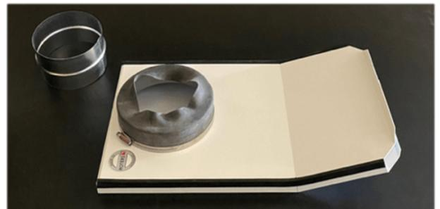
2. Den 150 mm Stutzen aus dem Reduziergummi ziehen.
