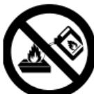
Questo simbolo avverte di non aggiungere combustibile liquido a Bio-Burner quando è acceso. Il combustibile liquido può prendere fuoco!
