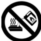
Dieses Symbol warnt davor, Flüssig-Brennstoff in den heißen Bio-Burner zu füllen. Der Flüssig-Brennstoff kann sich dabei entzünden!
