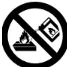
Dieses Symbol warnt davor, Flüssig-Brennstoff in den brennenden Bio-Burner zu füllen. Der Flüssig-Brennstoff kann sich dabei entzünden!
