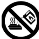
Este símbolo advierte de que no se debe verter combustible líquido en el Bio-Burner caliente. ¡El combustible líquido puede encenderse en el proceso!
