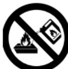
Este símbolo advierte de que no se debe verter combustible líquido en el Bio-Burner candente. ¡El combustible líquido puede encenderse en el proceso!
