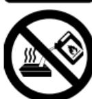
Ce symbole met en garde contre le fait de verser du combustible liquide dans le Bio-Burner chaud. Le combustible liquide peut s'enflammer !
