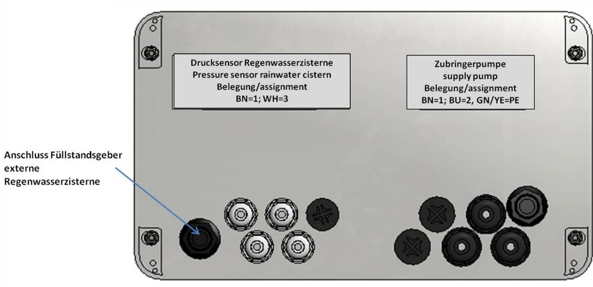
Abbildung 52: elektrischer Anschluss des Füllstandskabels an die *CONNECT*-Steuerung
