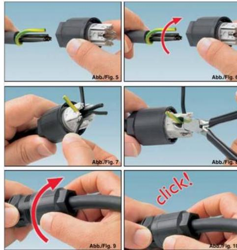
Abbildung 49: Elektrischer Anschluss der Netzleitung mit der Quickon-Mutter des H-Verteilers
