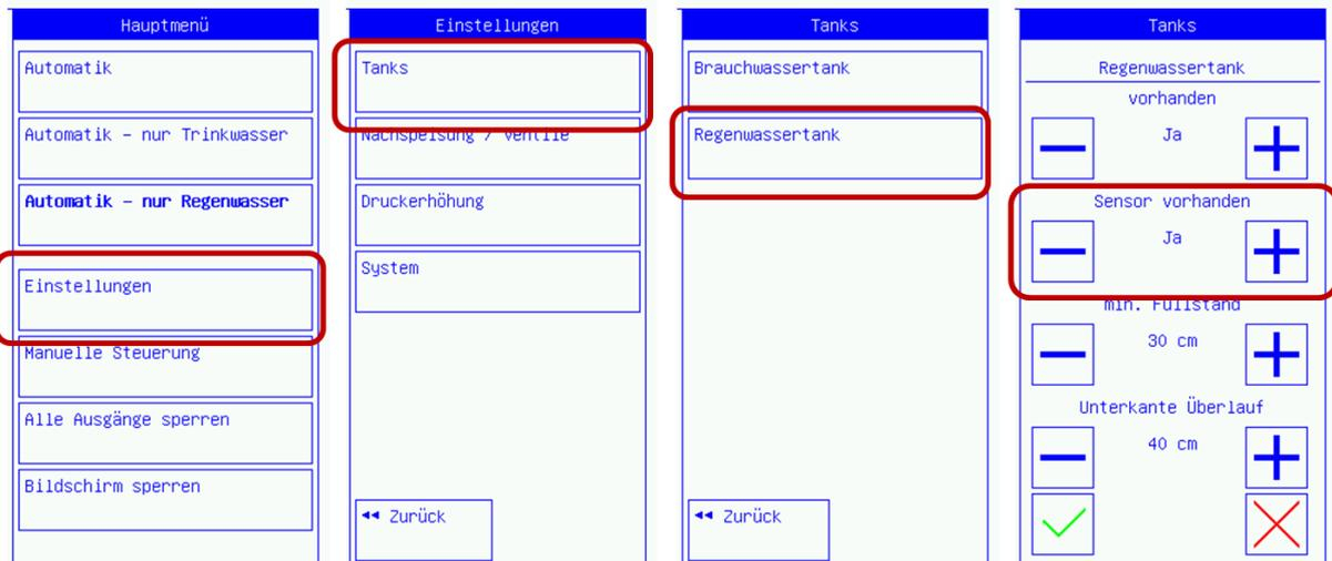
Abbildung 54: Freischalten des Sensors zur Visualisierung des Füllstandes
