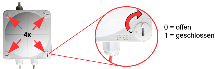
Abbildung 7: Deckel des Messwertaufnehmers aufsetzen und verschließen
