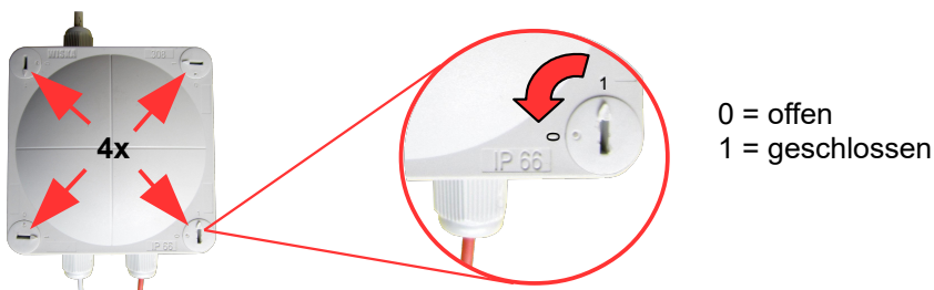
Abbildung 4: Deckel vom Messwertaufnehmer abnehmen
