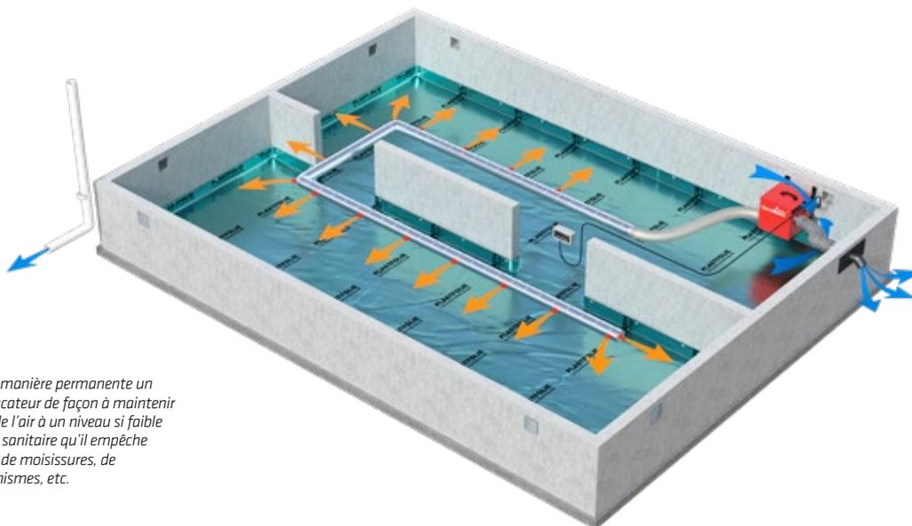
Installez de manière permanente un déshumidificateur de façon à maintenir l'humidité de l'air à un niveau si faible dans le vide sanitaire qu'il empêche l'apparition de moisissures, de micro-organismes, etc.
