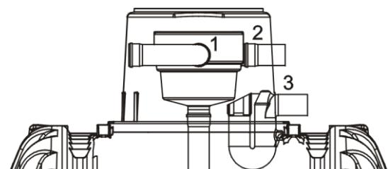
**Important:** Retirer le joint d'étanchéité du manchon pour le trop plein de sécurité.
