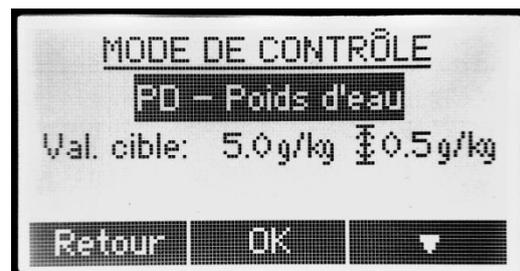
Les modes de contrôle externes exigent que la machine soit reliée en réseau et connectée à un capteur externe de température et d'HR. Si la machine n'est pas déjà en réseau, elle demande si vous souhaitez créer un réseau.
