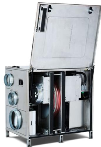
Die Klappe wird durch zwei Kompressionsverschlüsse geschlossen gehalten und lässt sich ohne Werkzeug öffnen. Auf diese Weise gelangen Sie schnell und einfach an den Rotor und die Komponenten.
