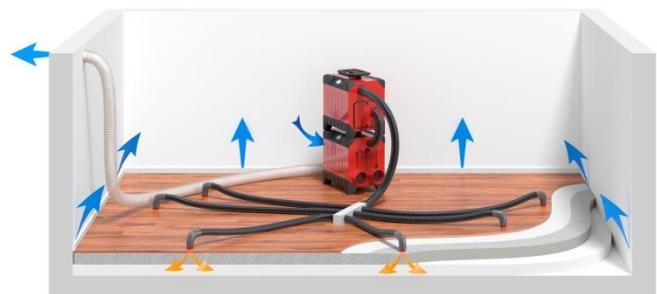
Drucktrocknung. Die Turbine wird vom Trockner mit trockener Luft gespeist und bläst diese dann in die geschichtete Konstruktion.
