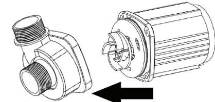
3. Pumpengehäuse entfernen
