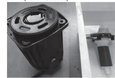
5. Das Pumpengehäuse aufrecht stellen und dieses mit milden Entkalker (Essigreiniger) füllen. Legen Sie das Laufrad in einen Plastikbehälter mit Entkalker. Beides lassen Sie nun 24h stehen. Nach 24h mit Wasser abspülen und Pumpe wieder zusammenbauen.
