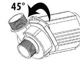
2. Pumpengehäuse 45° drehen im Gegenurzeigersinn (links)
