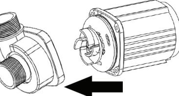
5. Zet pomphuis rechttop en vul deze met een milde ontkalker (zoals schoonmaakazijn). Leg de rotor in een plastic kom/bakje gevuld met hetzelfde anti-kalk middel en laat beiden 24 uur staan. Na 24 uur afspoelen met water en pomp weer assembleren.
