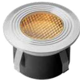
Onyx 60 RS (242D) Edelstahl 316 LED 1 W 2.700 K 5 lm 59 x 75 mm (H x Ø) Bohrdurchmesser 60 mm
