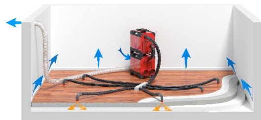
Drucktrocknung. Der Trockner versieht die Turbine mit Trockenluft. Danach drückt die Turbine die Luft in die geschichtete Konstruktion.
