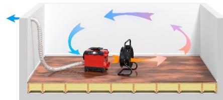
**Die Feuchtluft muss stets mithilfe eines Schlauchs aus dem zu trocknenden Raum abgeleitet werden. Das Bild zeigt die Raumtrocknung.**
