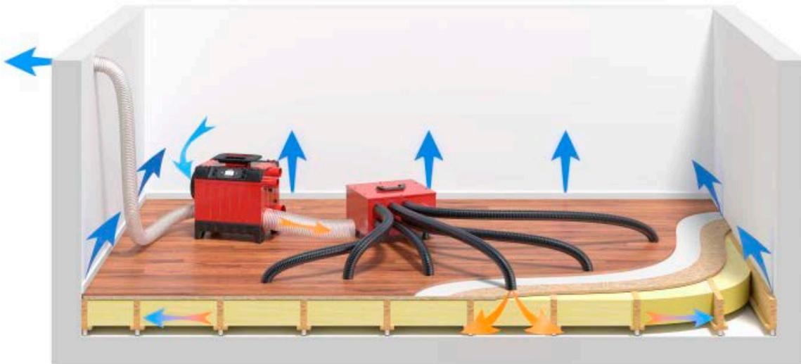
Assèchement par insufflation. Le ventilateur radial est alimenté en air sec par le déshumidificateur/déshydrateur, puis il refoule l'air dans la structure.
