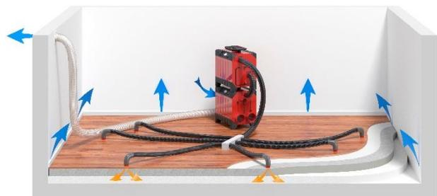
**Assèchement par surpression.** La turbine est alimentée en air sec par le déshumidificateur et envoie cet air dans la construction multicouches.
