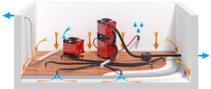
**Assèchement par aspiration.** Le déshumidificateur assèche l'air ambiant et la turbine aspire et évacue l'air de la construction. La dépression générée dans la construction y aspire l'air sec.
