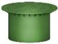
FAPARAIN Teleskop-Domschacht Maxi mit PE-Deckel begehbar ermöglicht das stufenlose Anpassen an gegebene Geländesituationen zwischen 455 und 755 mm. Flache Bauform für bündigen Abschluss mit der Grasnarbe, bis 5° neigbar. Komplett mit EPDM-Dichtung, abgedichtet bis Erdoberkante. Kindersichere Arretierung des Deckels über eine Edelstahl-Schraube mit M 10 Gewinde und einer Verdrehsicherung. Länge: 476 mm, D: Innen: 600 mm D: Aussen: 850 mm Farbe: Rasengrün
