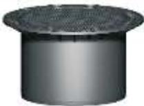
FAPARAIN Teleskop-Domschacht Guss mit Gussdeckel Klasse B ermöglicht das stufenlose Anpassen an gegebene Geländesituationen zwischen 455 und 755 mm Erdüberdeckung. Flache Bauform für einen bündigen Abschluss mit der Erdoberfläche bis 5° neigbar. Abgedichtet bis Erdoberkante durch EPDM-Dichtung. PKW-befahrbar Klasse B 125. Länge: 476 mm, D: Innen: 600 mm D: Aussen: 850 mm
