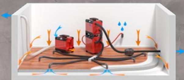
Die Abbildung zeigt eine Turbine bei der Vakuumtrocknung einer Bodenkonstruktion mit Wasserabscheider.
