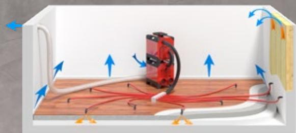
Durch das Drucktrocknen mit einem Trockner und einer Turbine können gleichzeitig Ständerwände und geschichtete Böden getrocknet werden.
