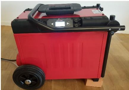
Um nach Abschluss des Trockenvorgangs das Auslaufen von Kondenswasser auf den Boden oder im Transportfahrzeug zu vermeiden, ist verbleibendes Kondenswasser aus dem Kondensator herauszupumpen. Lassen Sie den Schalter auf ON stehen und schalten Sie das Gerät ab, indem Sie an der Bedientafel auf „Stoppen“ drücken. Dann geht das Gerät in den Nachkühlmodus über, Lüfter und Pumpe laufen weitere 120 Sekunden lang, bevor das Gerät abschaltet. Kippen Sie
