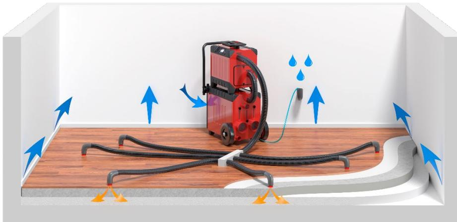
**DRUCKTROCKNUNG. DER TROCKNER VERSIEHT DIE TURBINE MIT TROCKENLUFT. DANACH DRÜCKT DIE TURBINE DIE TROCKENE LUFT IN DIE GESCHICHTETE KONSTRUKTION.**
