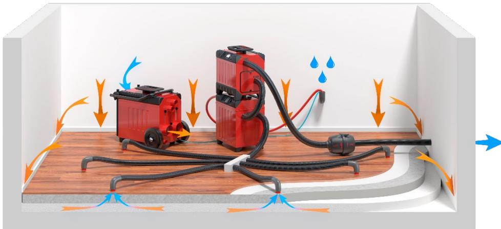
**VAKUUMTROCKNUNG. DER TROCKNER TROCKNET DIE LUFT IM RAUM, UND DIE TURBINE ZIEHT LUFT AUS DER SCHICHTKONSTRUKTION NACH OBEN, WODURCH TROCKENE LUFT IN DIE KONSTRUKTION EINGESAUGT WIRD.**
