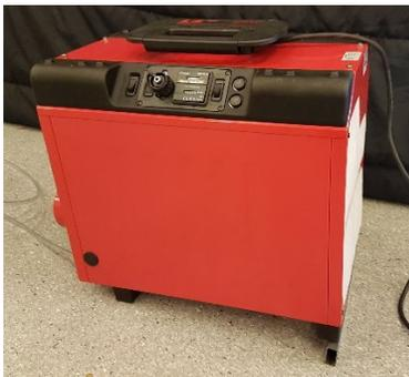
Um nach Abschluss des Trockenvorgangs das Auslaufen von Kondenswasser auf den Boden oder im Transportfahrzeug zu vermeiden, ist verbleibendes Kondenswasser aus dem Kondensator herauszupumpen. Stellen Sie den Schalter MAN/HYG auf HYG ohne Anschluss eines externen Hygrostats. Kippen Sie den L4 am besten gemäß Abb. und lassen Sie die Pumpe das restliche Kondenswasser von Kondensator und Bodenwanne abpumpen.
