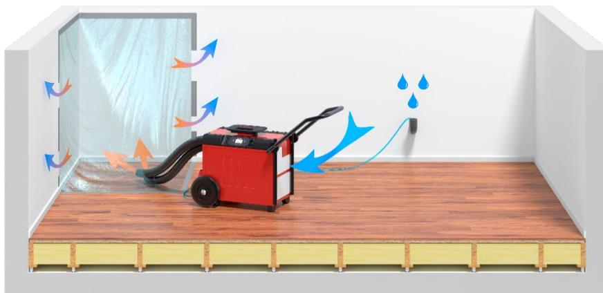
**TROCKNEN EINES ÖRTLICH BEGRENZTEN WASSERSCHADENS – KÜRZERE TROCKENZEIT UND GERINGERER ENERGIEVERBRAUCH DANK ABKLEBEN.**
