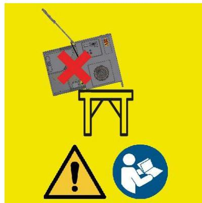
Am Verriegelungsmechanismus der Rotorkassette ist ein Warnsymbol angebracht. Dieses erinnert an die oben genannte Warnung, falls die Lichtverhältnisse oder andere Umstände dazu führen, dass diese nicht erkannt oder vergessen wurde.
