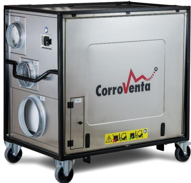
Der Abstand zwischen den Füßen der Maschine ermöglicht das Heben mit einem Gabelstapler oder Palettenhubwagen mit einem Gabelabstand für herkömmliche Europaletten. Bei allen Transport- und Hubarbeiten ist Folgendes sicherzustellen:
