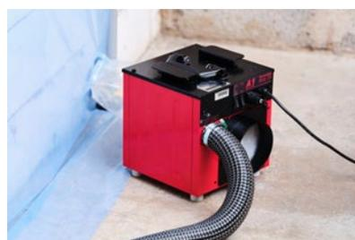
Der kleine und leistungsstarke Trockner ist ideal für die Verwendung mit Kunststofffolie geeignet, um den Trocknungsprozess zu optimieren und Energie zu sparen.
